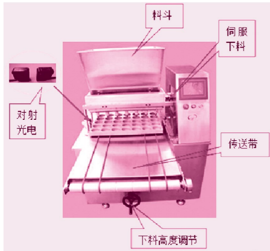
图5 全自动注浆机整体结构解析
