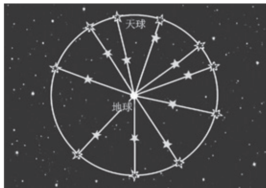
图 1.28 天球的半径是任意的,所有天体,不论多远,都可以在天球上有它们的投影。这里显示的是地心天球,主要用来研究天体的视运动。替代地球,以太阳为中心的天球叫日心天球,主要用来进行天体运动研究的动力学计算
