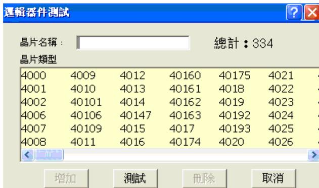
本選項按照 TEST .LIB 中的測試模式對 TTL 或 CMOS 邏輯器件進行測試，敲入器件類型名或按〈Enter〉鍵顯示所有類型，移動亮條選擇，開始測試。測試結束後，顯示通過或失敗的資訊。
