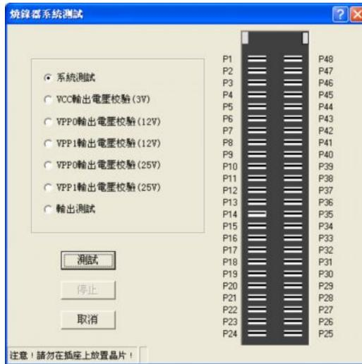
本功能表用於對編程器的鎖緊插座進行功能檢測，對編程器故障進行初步診斷。
