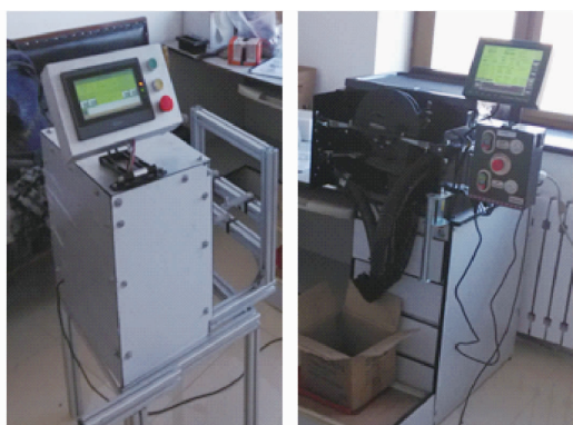
图 11 本文检测仪(左)与 MeterMax 型排种器检测仪(右)的对比试验
