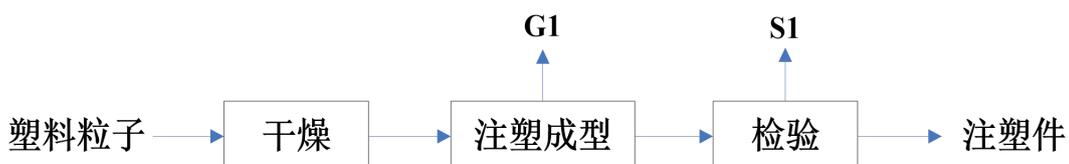
图 5-2 接线盒外壳生产工艺流程图
