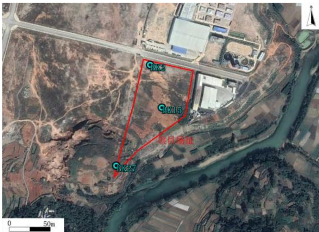
图 5.2-2 场区工程地质勘探孔平面布置图
