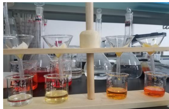
照片 11 通过过滤将留在溶液中的土去掉
