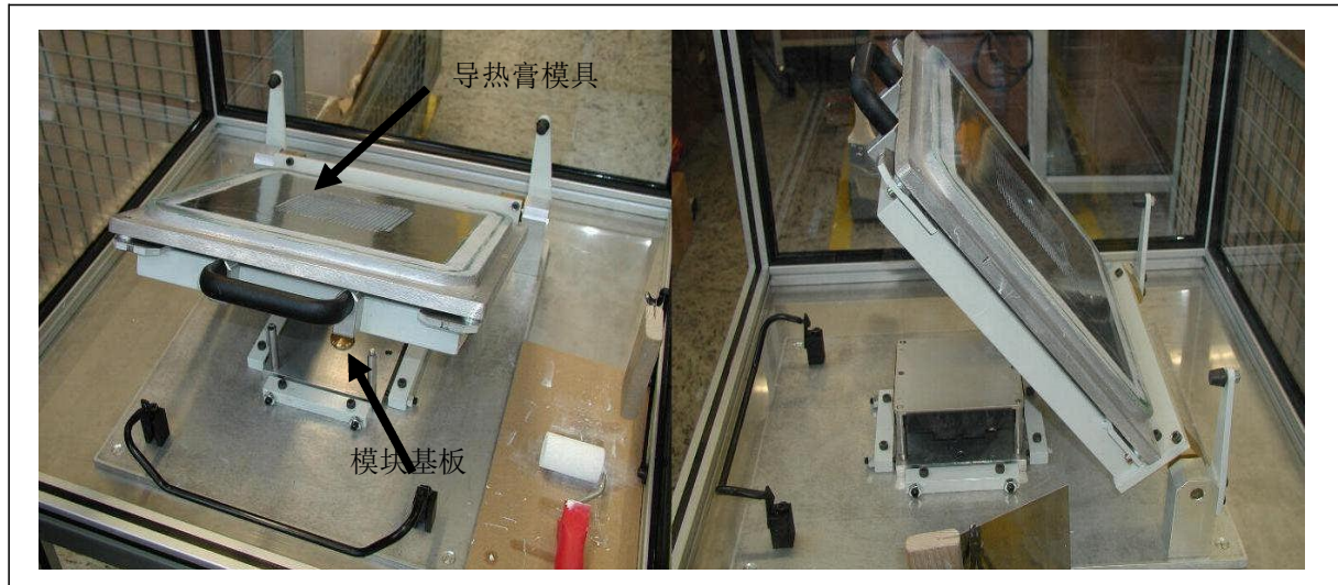
图. 6: 丝网印刷过程中使用敷涂夹具敷涂导热膏示例，模块基板细节
