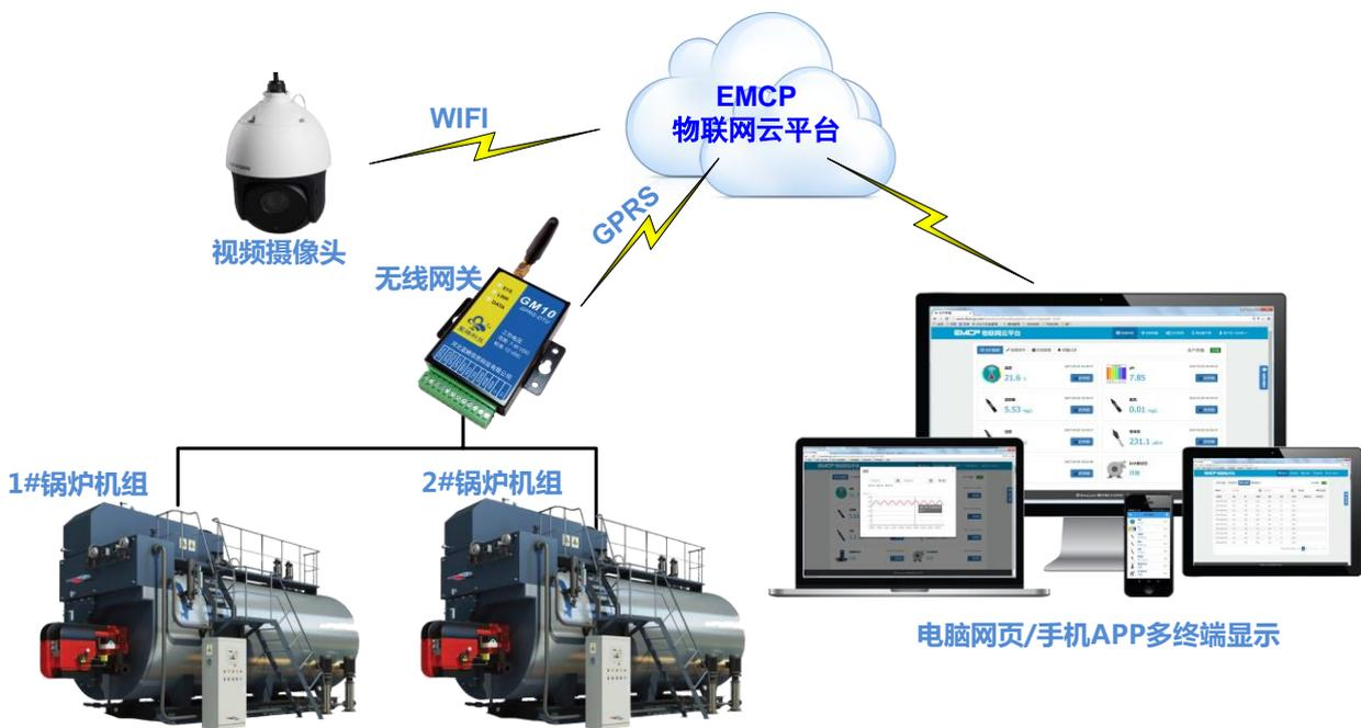
首先将锅炉控制箱内的 PLC 通过 RS485 总线和 GM10-DTU 连接起来，通过电脑给 GM10 进行参数配置，登陆 EMCP 物联网云平台，添加设备，添加规则、添加用户等操作。所有配置工作完成后我们只需打开电脑 Web 网页或查看和控制水泵房中的设备。在登陆页手机扫描二维码下载《云联物通 APP》，登陆 APP 后，
