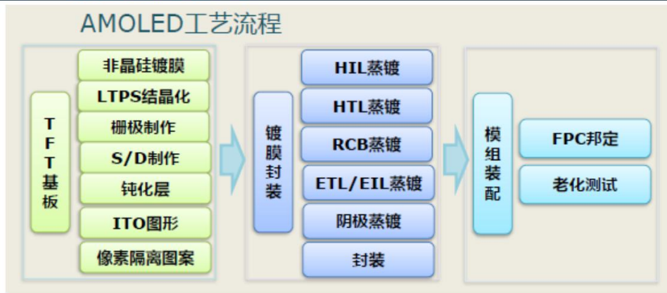
图 16: OLED 各道工序及相应设备一览
