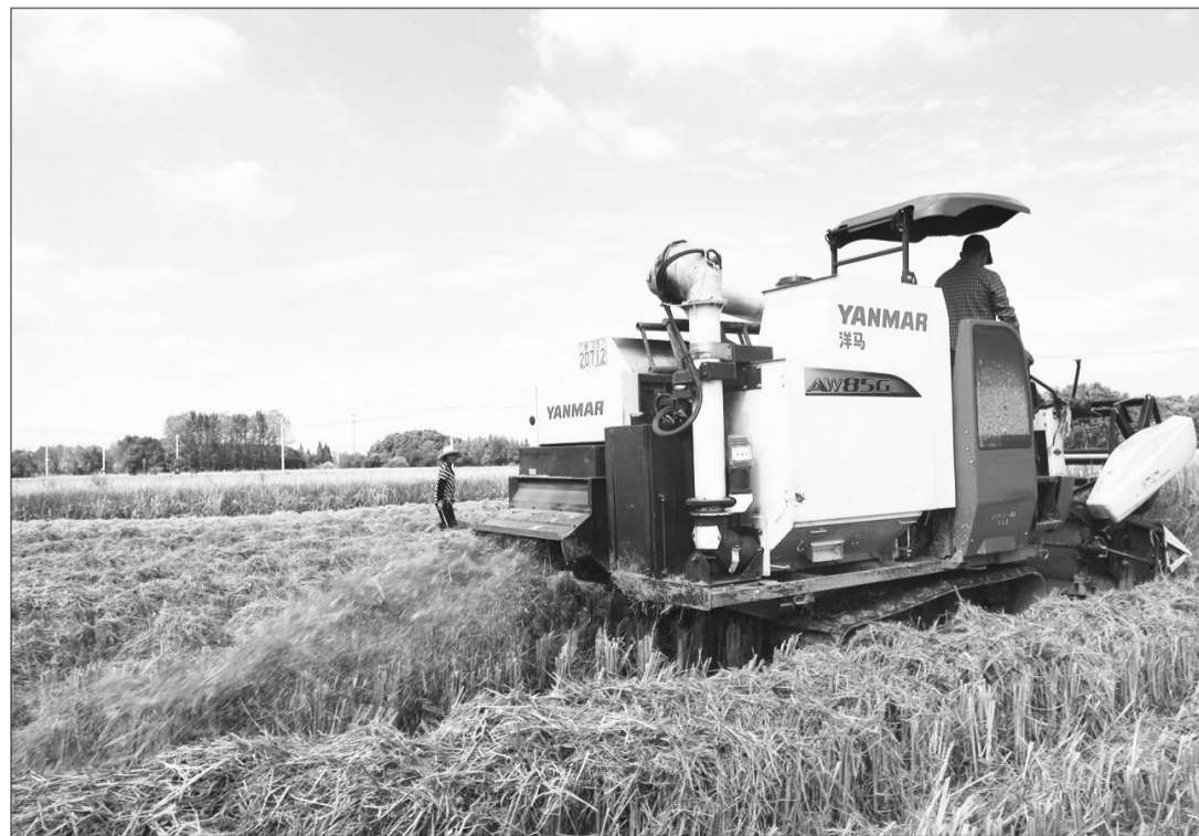
浙江省安吉县递铺街道兰田村近日利用联合收割机在田头收割杂交稻。联合收割机直接把粉碎的秸秆覆盖在田头,不仅增加土地的肥力,同时杜绝秸秆焚烧造成大气污染。人民图片网供图
