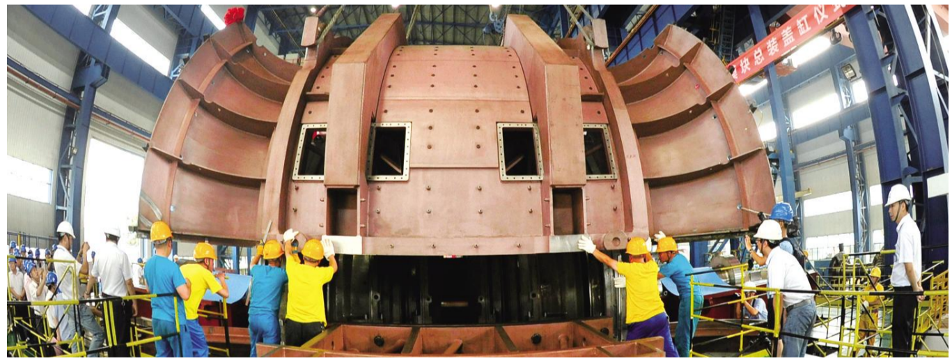
国核示范项目1号机LP2模块在东汽总装
