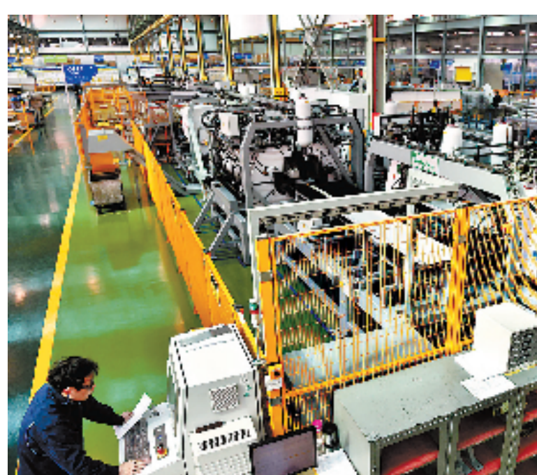
杭州江干区科技经济园西子奥的斯电梯公司的员工正在流水线上操作。这条从荷兰引进的全自动威猛门板流水线,只需要6位员工就可以完成钢板到装箱的流程,大大节约了人工成本,9秒就完成一扇门板。据了解,该公司通过优化生产线,提升机器人的自动化比例,目前人均年生产电梯159台,预计全年生产电梯35000台。 本报记者 梁臻 通讯员 杨元元 摄
