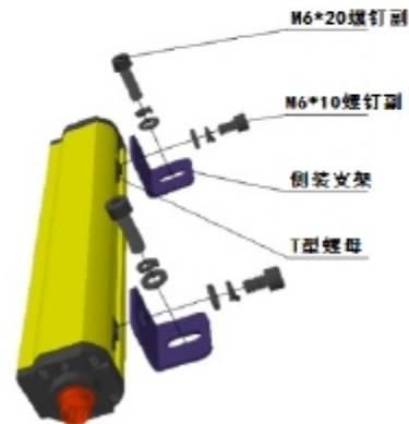
(一) 侧装方式—侧装支架
