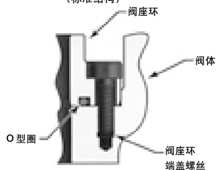
O型圈垫圈结构 (作为标准结构用于酸性气体工况, 也可作为可选结构用于其它工况)
