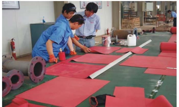
耐磨防腐衬胶管道制作车间
