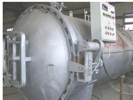
防腐衬胶管道热硫化设备
