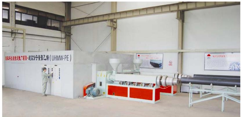
超高分子量耐磨管道生产线
