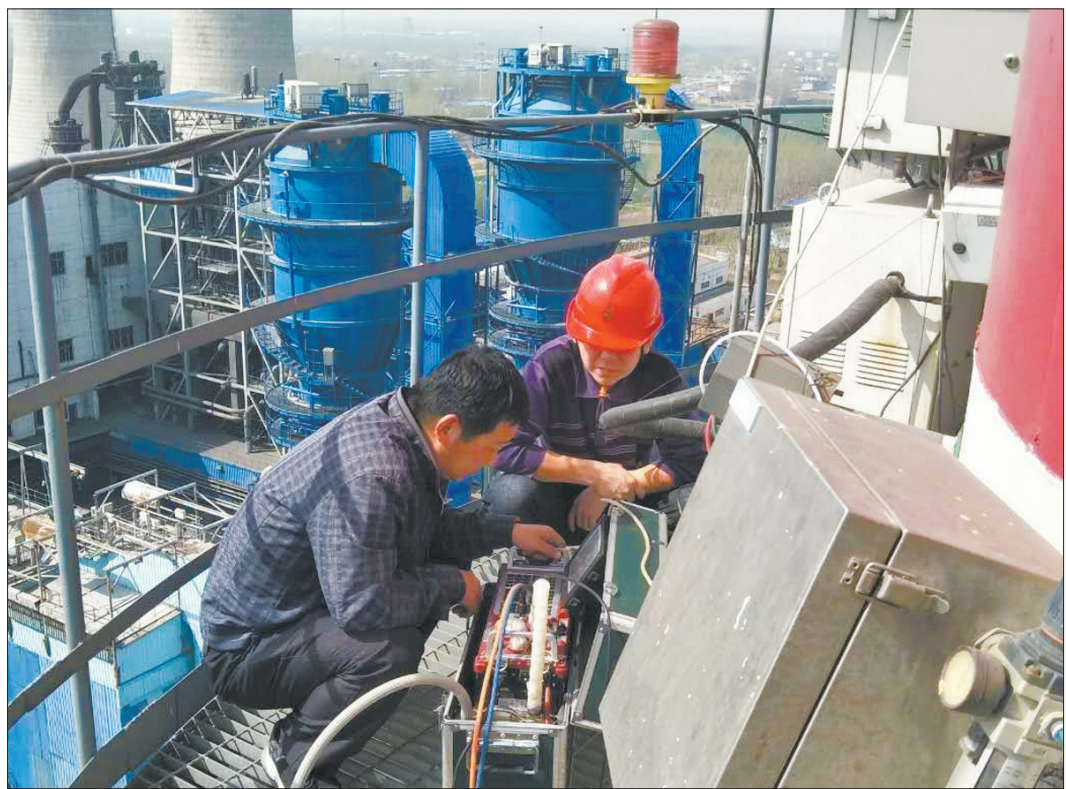
山东省莘县在用好在线监测系统的同时,加密人工监测频次,对环境监测数据造假“零容忍”。图为莘县环境监测人员日前在50米高的莘县鑫源热电有限公司烟气监测平台上开展现场监测。张彦鲁 王文硕摄
