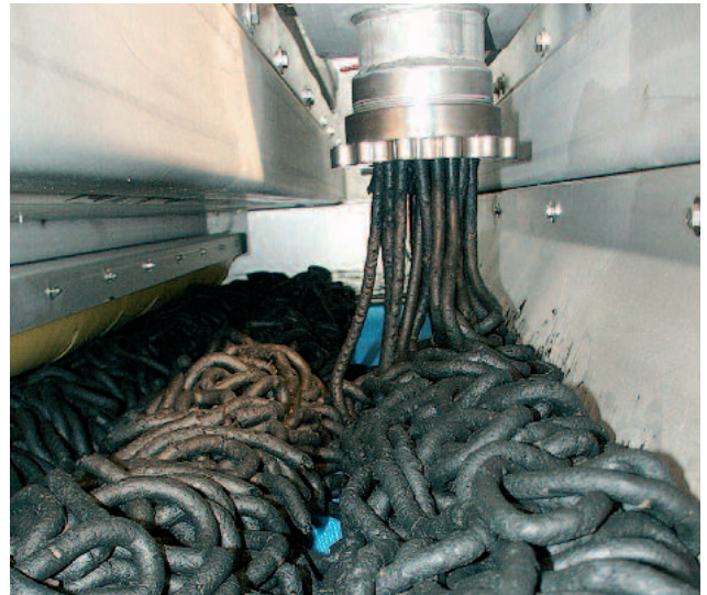
采用面条机进行污泥布料是HUBER 带式干化装置高效处理的关键工艺步骤
