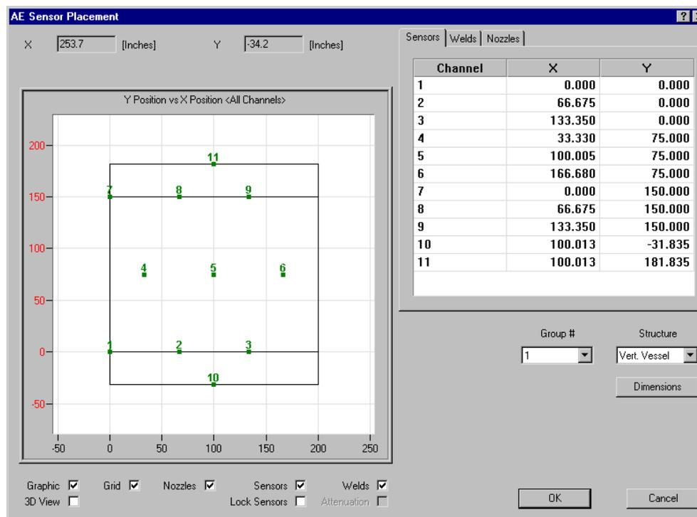
图 112. Cylinder Sensor Placement (圆柱体传感器布置)
