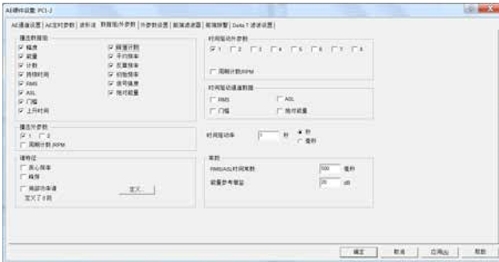
Parametric Setup（参数设置）页将允许你依比例衡量测量参数输入的电压，如系统显示的相应的载荷或压力值，同样允许你告知系统你需要在显示图形或打印输出的坐标
