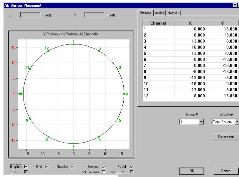
图 135. Tank Bottom Sensor Placement (油罐罐底传感器布)
