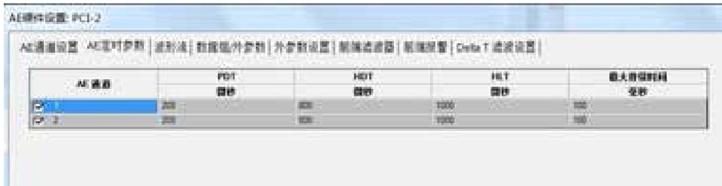
PDT, HDT 及 HLT 是信号检测过程中的时间参数，它们的功能在附录 4 中全面讨论。这里简述如下：PDT 的正确设置将确保正确鉴别信号峰值的上升时间及峰值幅度的检测。HDT 的正确设置将确保结构中的一个 AE 信号反映到系统中的是一个且仅为一个 hit。HLT 的正确设置将避免信号衰减时的非真实检测及提高数据采集速度。对于各种试验的推荐值如下：
