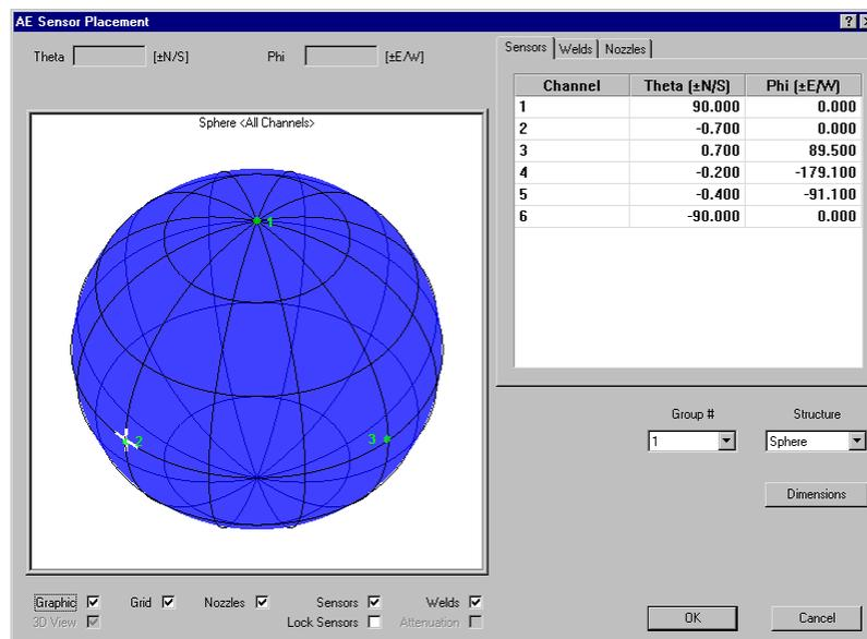
图 106. Spherical Sensor Placement (球形的传感器布置)
