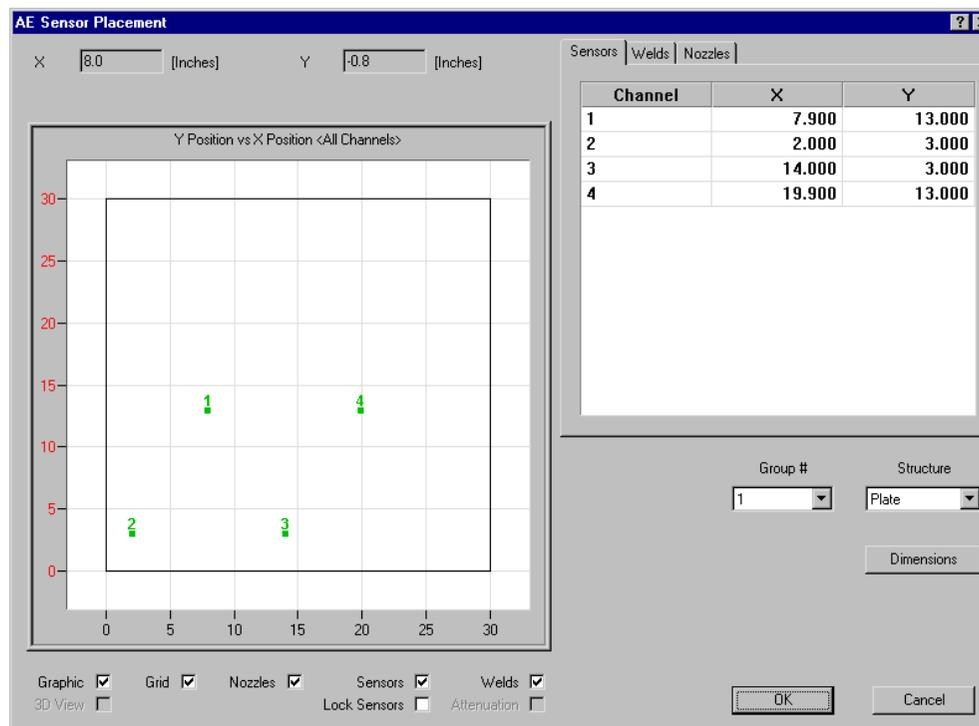
图 93. 2D Planar Sensor Placement (2D 平面传感器布置)
