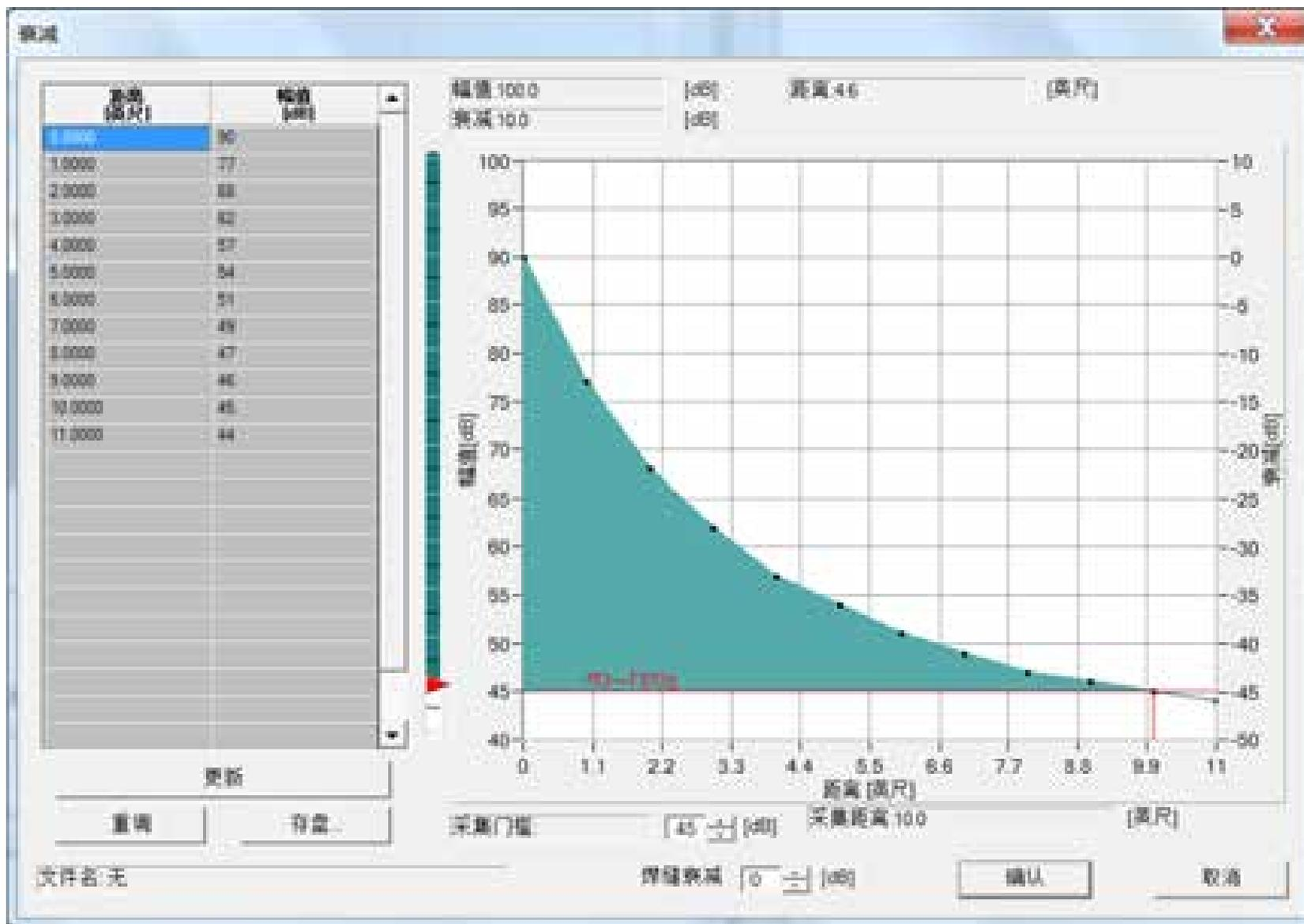
按键打开衰减对话框。这个对话框的唯一目的是使得软件计算声发射源的幅值以及声发射的距离衰减。如图 84 所示。
