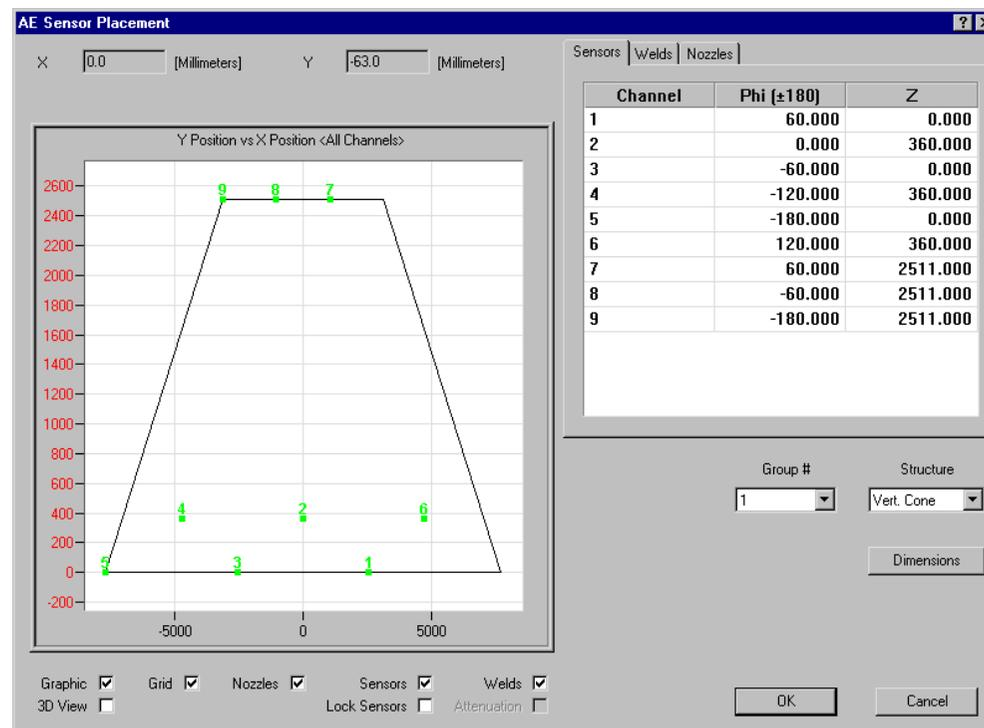
图 118. Conical Sensor Placement (圆锥传感器布置)
