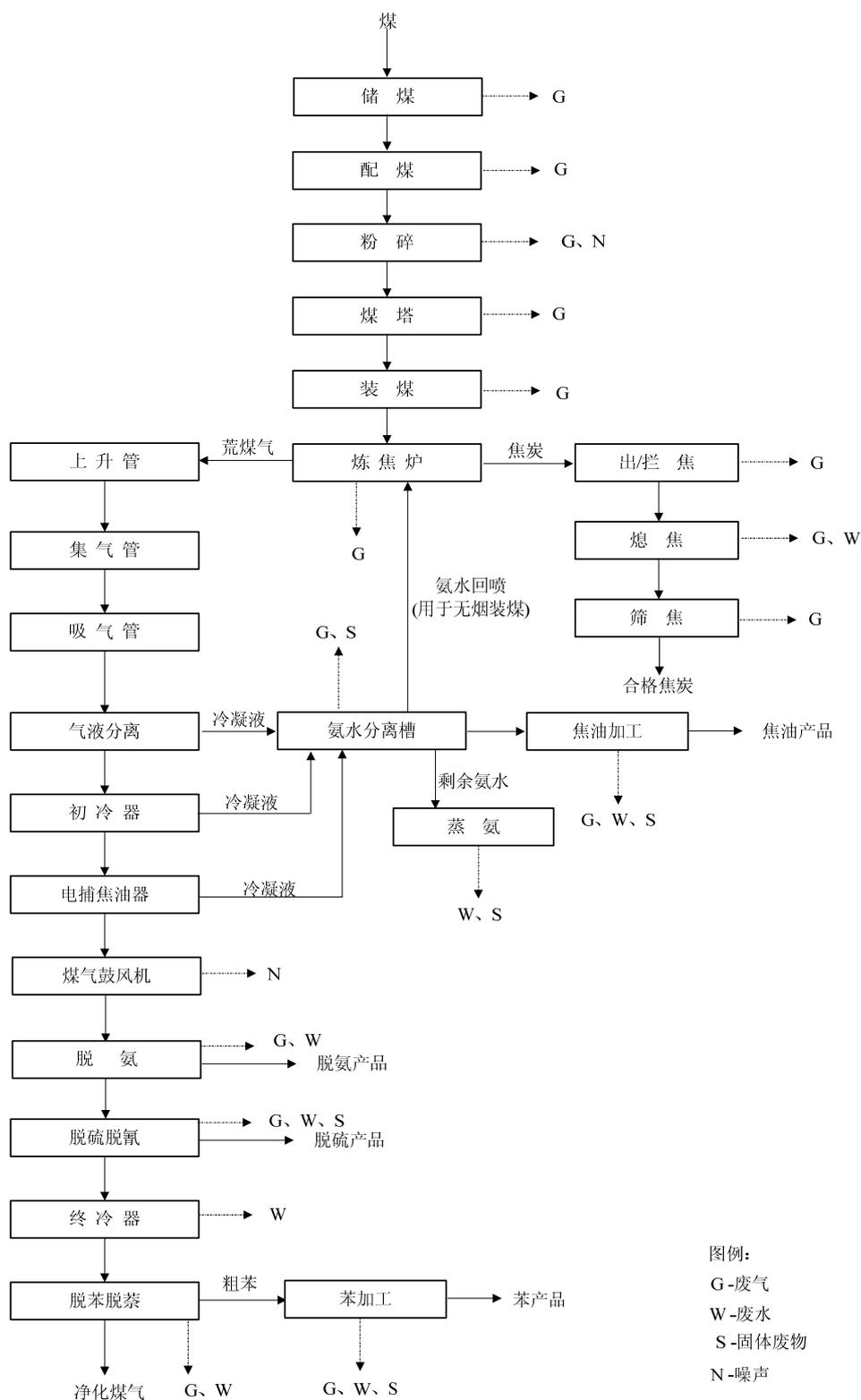
图 1 焦化工艺流程及产污环节
