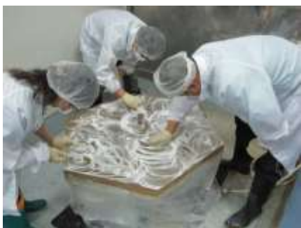
左图为维护人员在为镀膜后的 MA 子镜抛光；右图为镀膜后的子镜。
