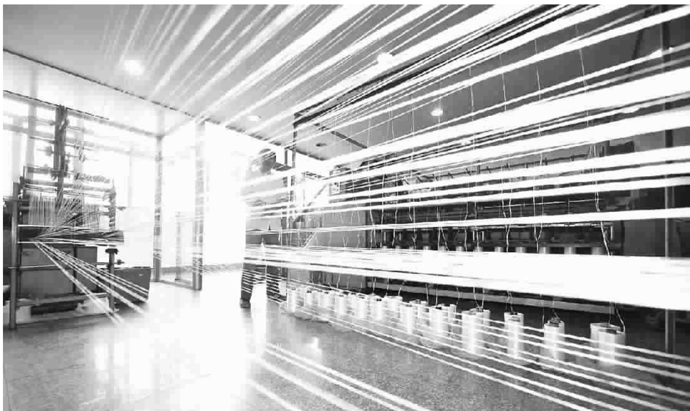
■ 东华大学校园内的碳纤维生产流水线
