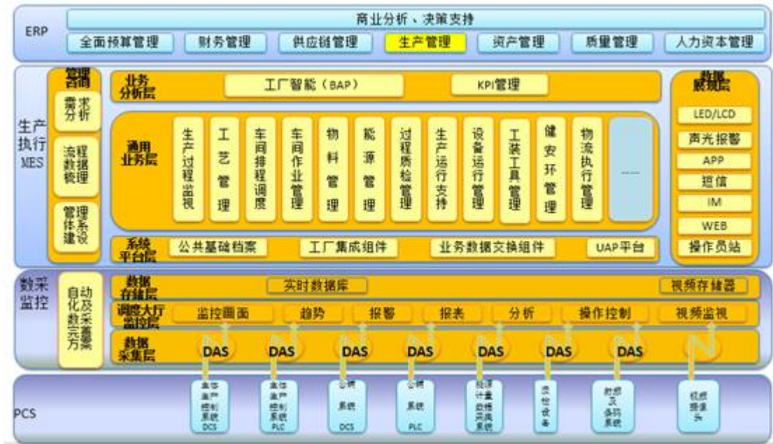
图 4-16 MES 系统结构示意图
