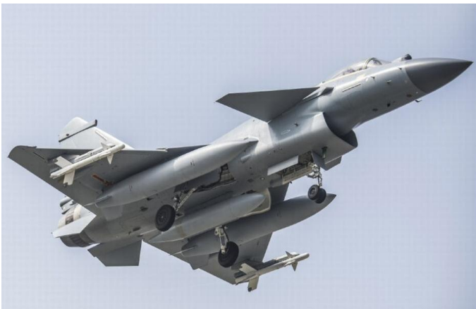
图表 34：安装了 WS10 发动机的歼 10B 挂弹试飞
