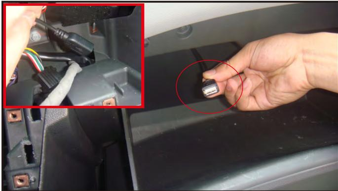
27.将专用机显示屏后USB数据线如图方式放置于杂物箱内。
