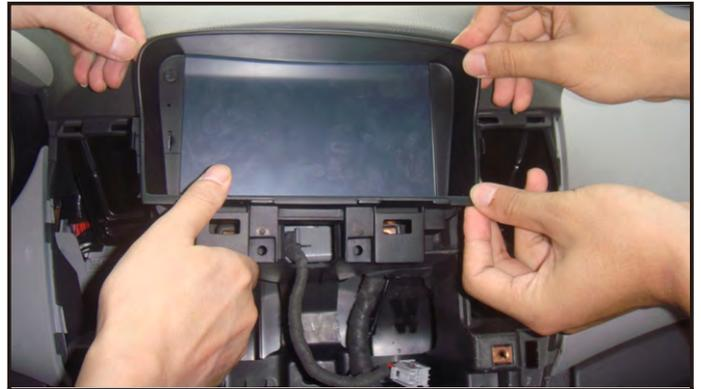
28.将专用机显示屏部分束插好装入车上并打好固定螺丝（注意卡扣）。
