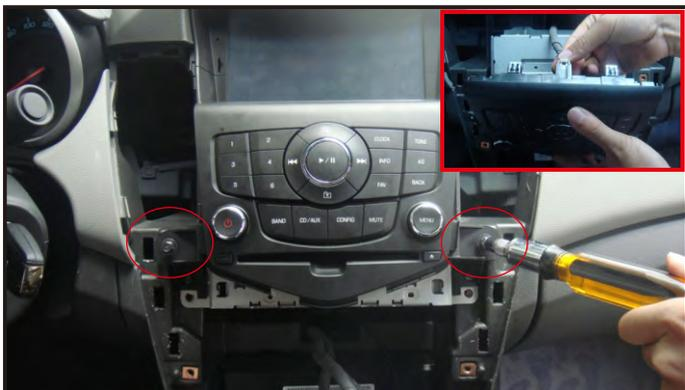
29.将原车主机面板线束插好，安装好并打上其固定螺丝。
