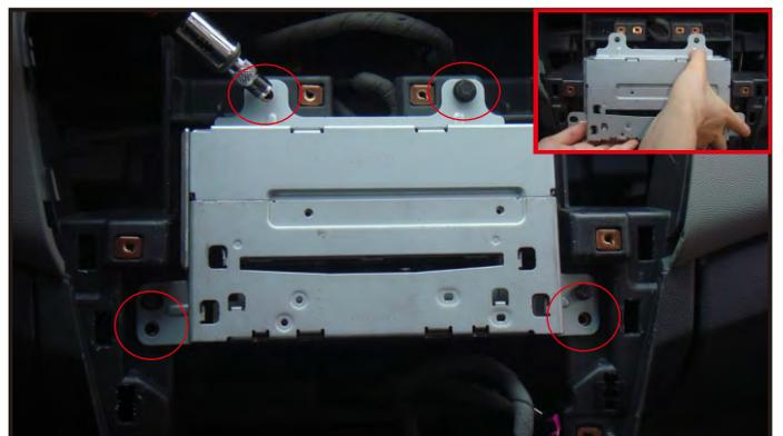
8. 拆除原车主机箱固定螺丝，并取出机箱（注意拔掉其后部线束）。
