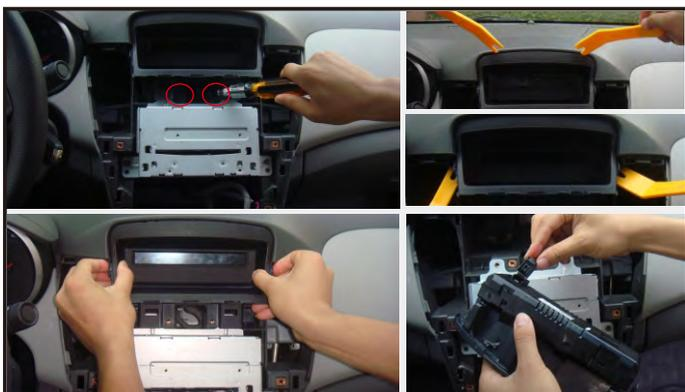
7. 拆除原车屏固定螺丝，并将屏拆下（注意各卡扣和线束）。
