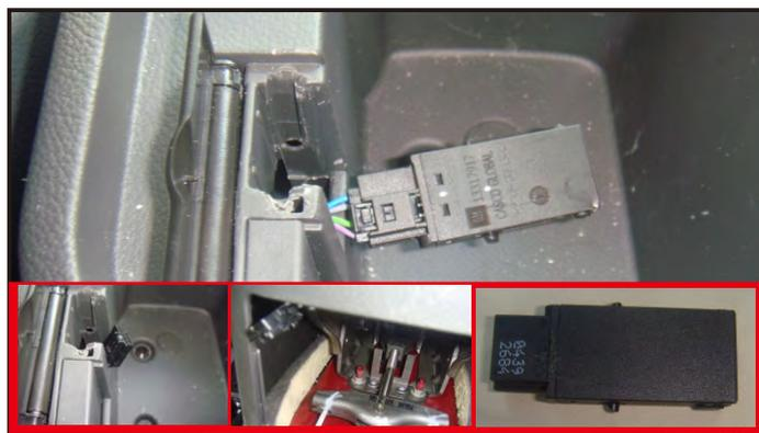
16.拆掉AUX插座数据线插头，将插头线从杂物盒后部拉出，并把AUX插座装回原位置。
