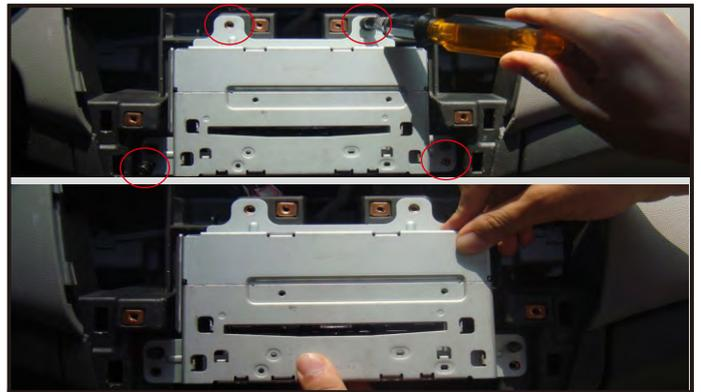
26.布好DVD连接线，将改装好的机箱装入车内插好线束并打好固定螺丝。
