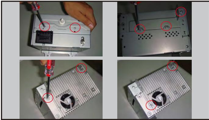
25.将专用机DVD部分安装到拆卸好的原车机箱上，并打上图示四面螺丝。
