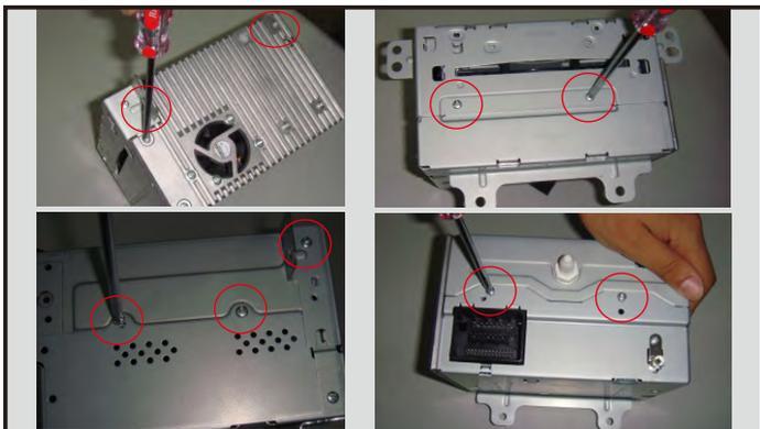
21.拆除原车主机机箱图示四面螺丝。
