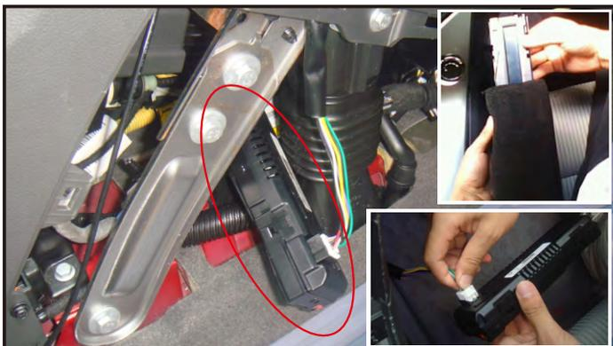
19.将原车屏装到保护套内并插好线束，装到图示空隙处用扎带固定好。
