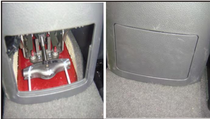
17.将两插头对接，注意把线理好，以免影响到接手刹，装回盖板。
