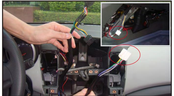
18.将屏转换线双头端从原车屏位置拉出，另一端引到左边下部护板处。
