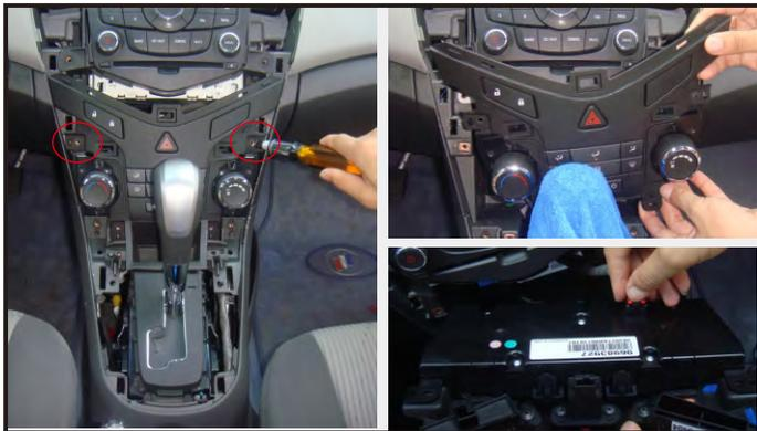
5. 拆除空调面板固定螺丝，并将空调面板取下（注意其后部线束）。
