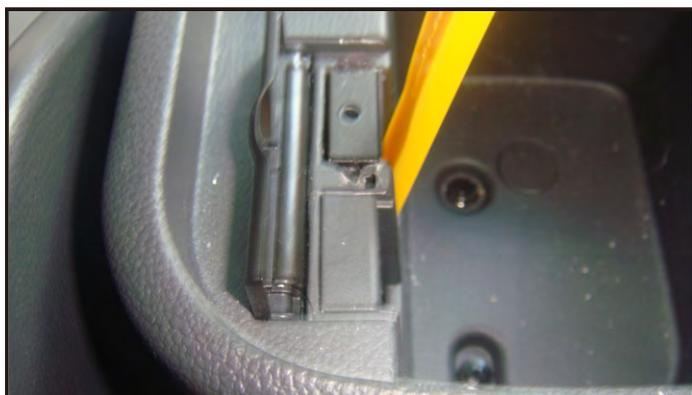
15.用塑胶撬板拆下原车AUX插座。
