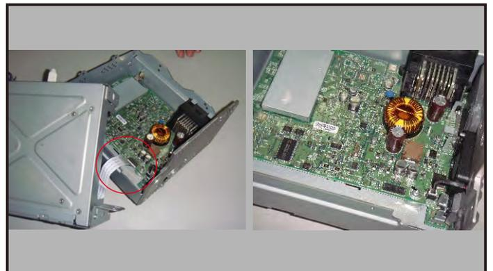
22.将原车机箱上的机芯部分拆卸掉，并拔掉图示排线。
