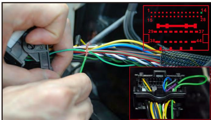
13.将AUX线的绿色数据线与原机绿色线（14脚）接好并用电工胶包好。
