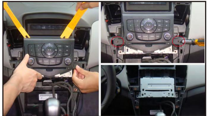
6. 拆除原车主机面板固定螺丝，并将其取下（注意各个卡扣）。
