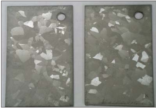
圖 17 中和立體交叉工程現場吊掛暴露試片
