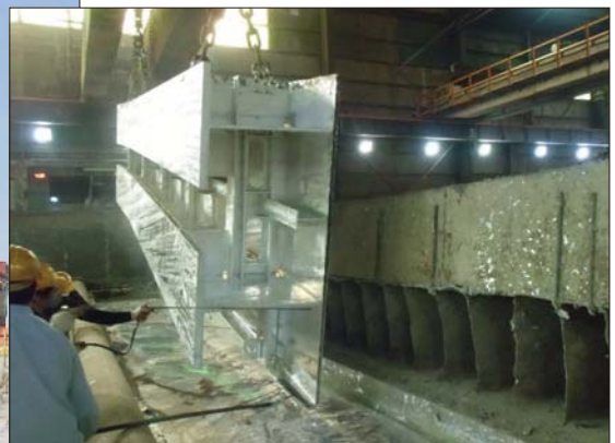
圖 18 桃園宏大橋，箱梁鍍鋅時採翻轉 90 度方向浸鍍
