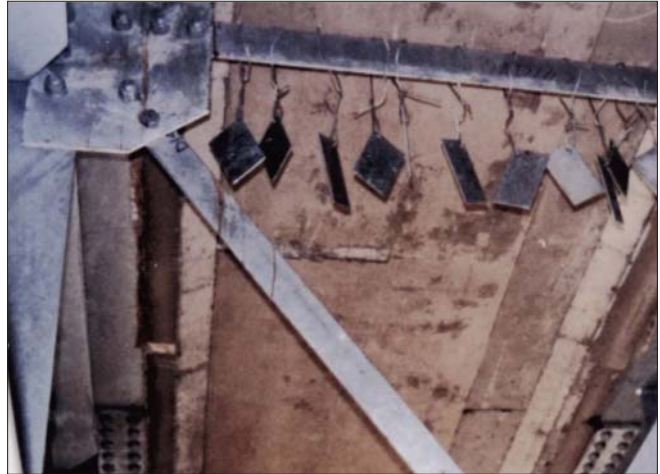
圖 17 中和立體交叉工程現場吊掛暴露試片
