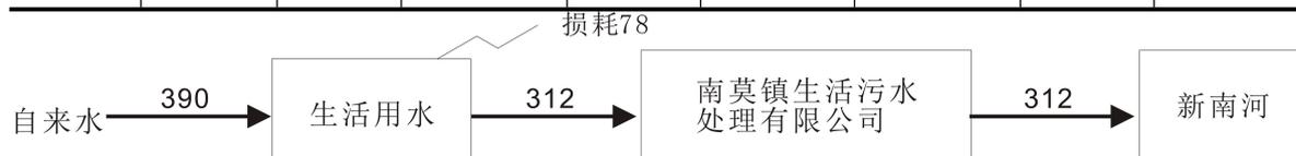
图 5-2 建设项目水平衡图 单位:m<sup>3</sup>/a
