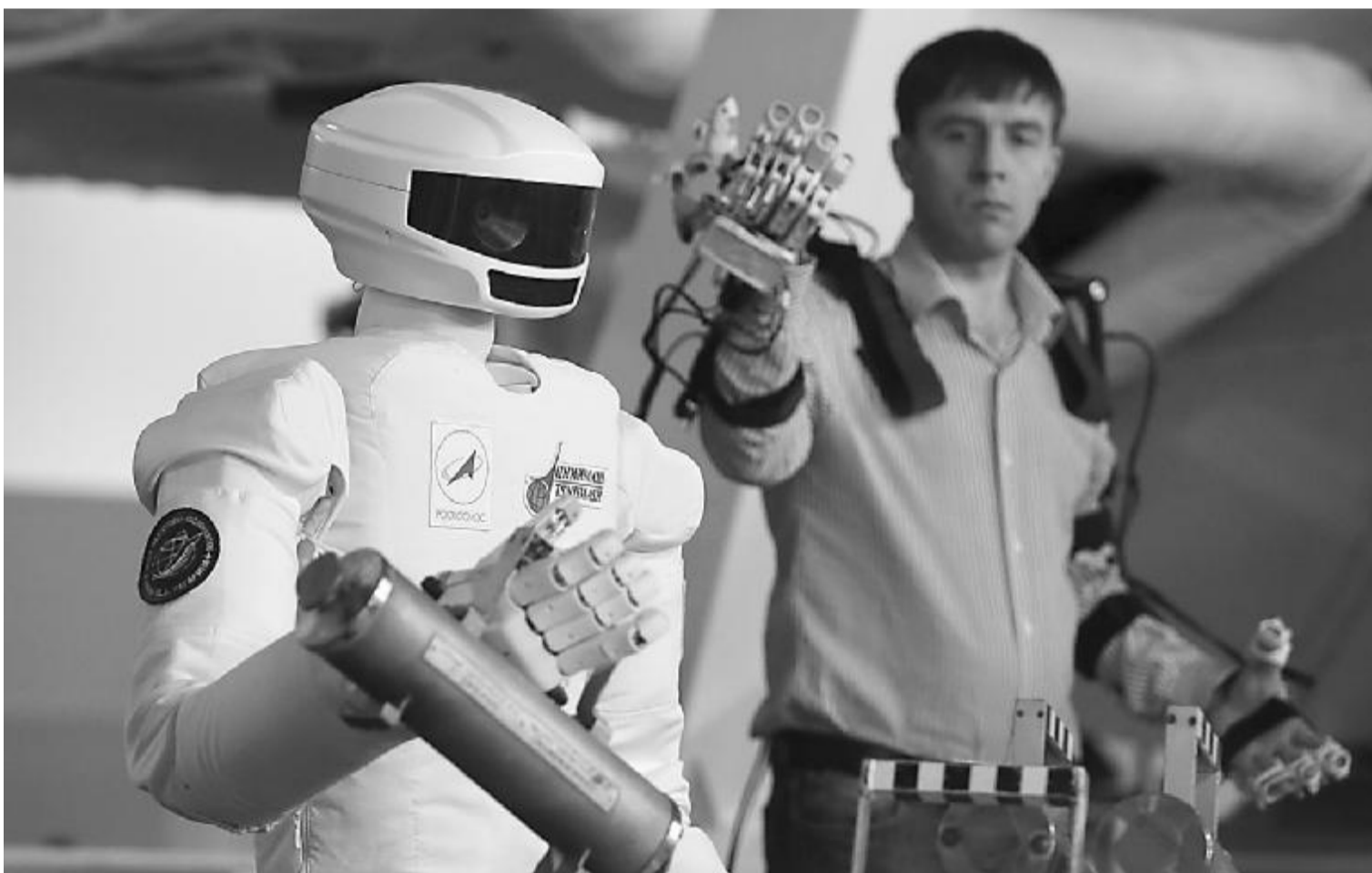
当地时间11月27日,空间类人型智能机器人SAR-401在俄罗斯星城亮相。该机器人重144公斤,双手能够举起10公斤物体,手指能做出比较灵活的关节动作;此外,这款机器人还能通过触觉转化声音与图像。它将在太空活动中有所运用。CFP供图
