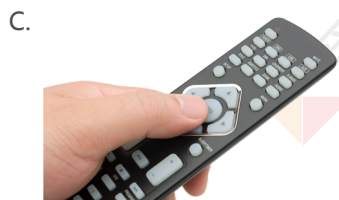
遥控器利用红外线实现对电视机的控制
