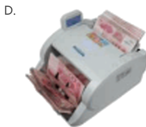
验钞机利用紫外线使钞票上的荧光物质发光
