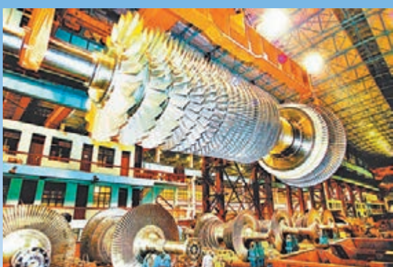
■德陽的東方汽輪機廠生產的大型燃氣輪機轉子吊裝
