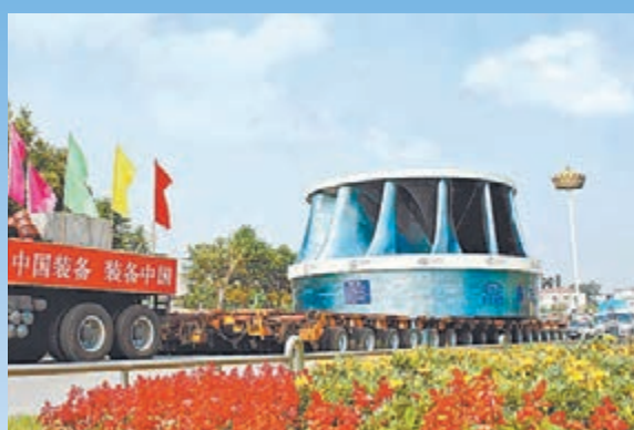
■德陽的東方電機廠電生產的具有完全自主知識產權的三峽右岸700MW水輪機轉輪發運出廠
