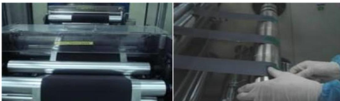
图 5-5 辊压机压薄及分切极片
