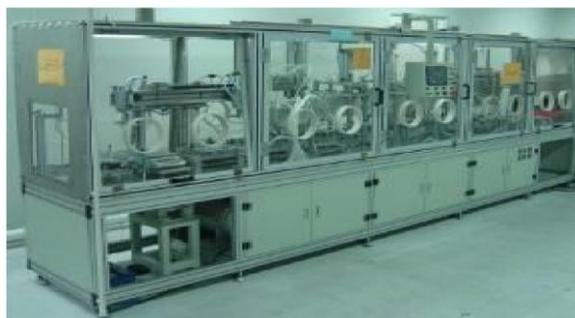
图 5-7 全封闭的自动注液机示意图
