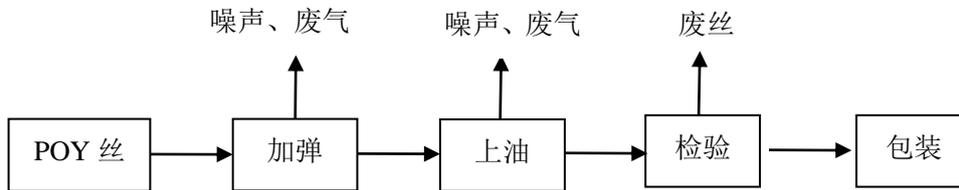
图 5-1 生产工艺流程图
