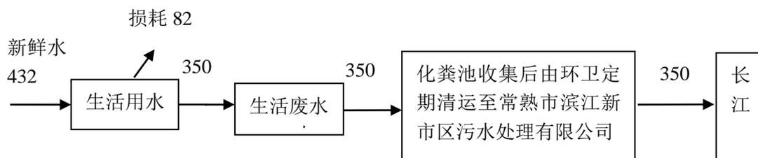
图 1-2 现有项目水平衡图 (t/d)
