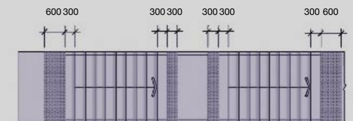
Location of hazard warning tile for stairs 在樓梯處設置危險警告引路磚的位置
