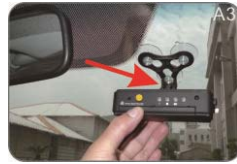
將吸盤架調好角度，於前擋玻璃最佳位置貼緊密合
