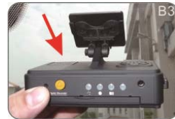
將主機支架循著卡榫滑入固定卡住
