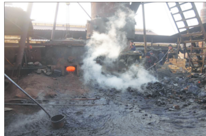
河北省沧州市安庄村无名铸造企业使用冲天炉炼铁,烟尘排放严重。环境保护部供图
