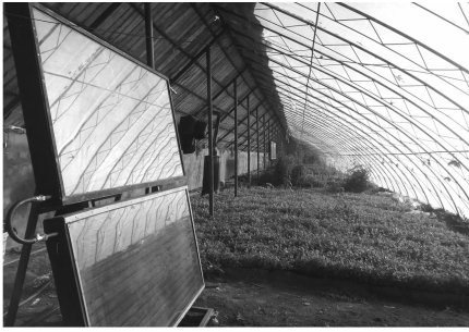
图4 太阳能井水增温装置试验实景
