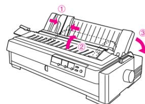
將上方導紙板裝回，並將上方導紙板左、右兩邊的紙張邊緣定位器移到中間，然後關上導紙板護蓋
