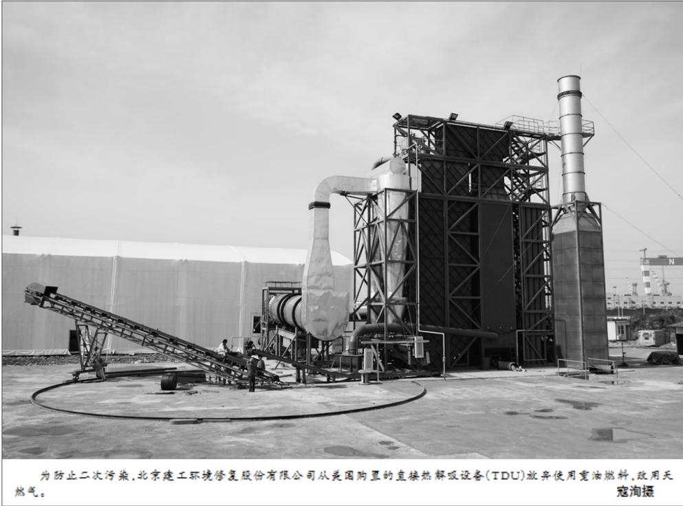
为防止二次污染,北京建工环境修复股份有限公司从美国购置的直接热解吸设备(TDU)放弃使用重油燃料,改用无氮液。
