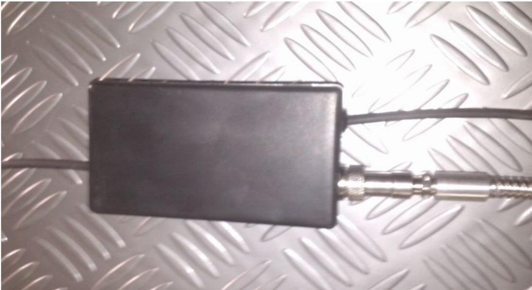
整个地毯感应系统的总功耗 $<0.5W$ 。由外接24V直流电源提供电力。当有人或重物作用于地毯表面，使地毯内的弹性光纤发生变形。控制器就会发出开关量信号给监控系统或报警器。
