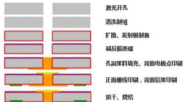
图 20：P 型硅基 MWT 电池基本工艺流程
