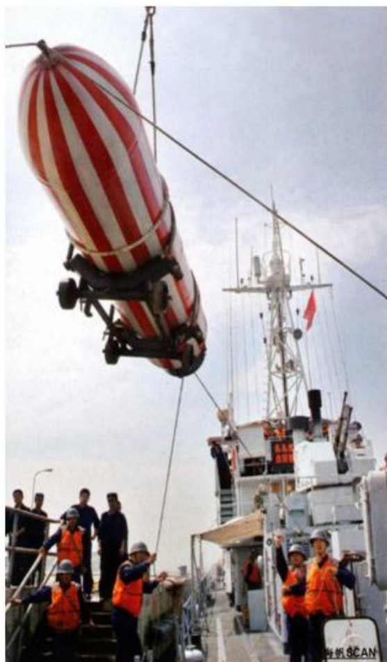
照片 4. 施放训练用沉底雷。如同照片中的沉底雷操演的环境因素一样，施放水雷的条件包含了吊架、合适的甲板空间、全球定位系
