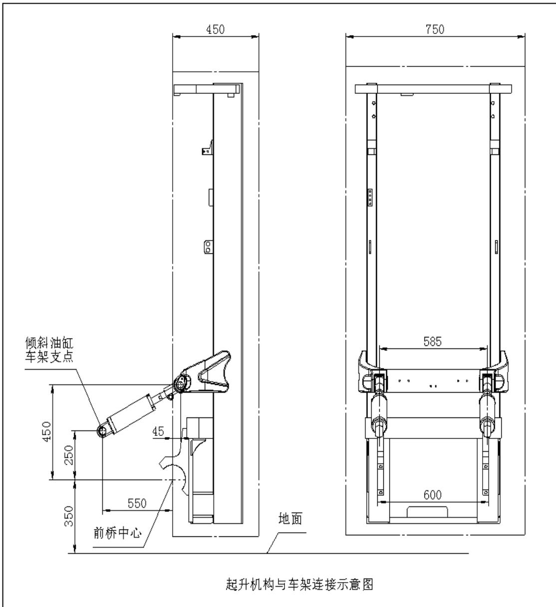
注：车架支点和前桥中心是起升系统和整车连接两点约束，连接方式不限，可不采用倾斜油缸。
