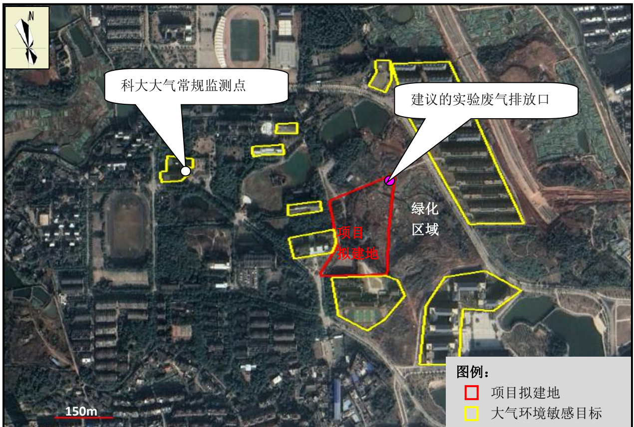
图 7-1 项目废气排放口位置建议图
