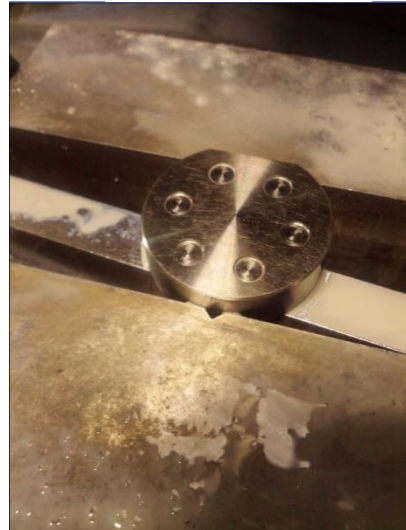
钛合金铣削沉孔 (无毛刺)
