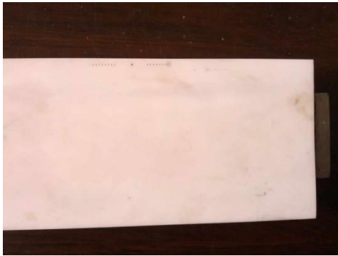
氧化锆陶瓷 钻孔 \Phi 0.25\text{mm} ， 深度 2mm
