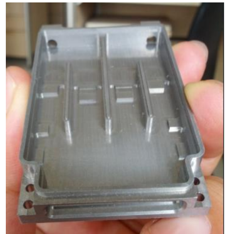
铣槽和台阶，无明显崩边。
