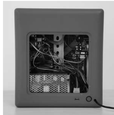
Figure 9. Internal structure of QR-code control box 图 9. 二维码控制盒内部结构
