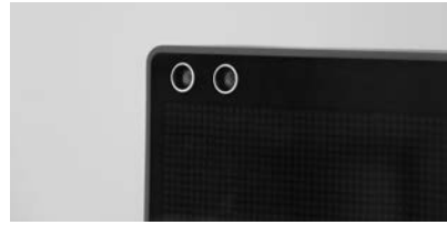
Figure 8. Ultrasonic Ranging Module of QR-code control box 图 8. 二维码控制盒超声波测距模块
