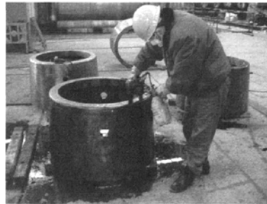
图10 风口大套磁粉检测
