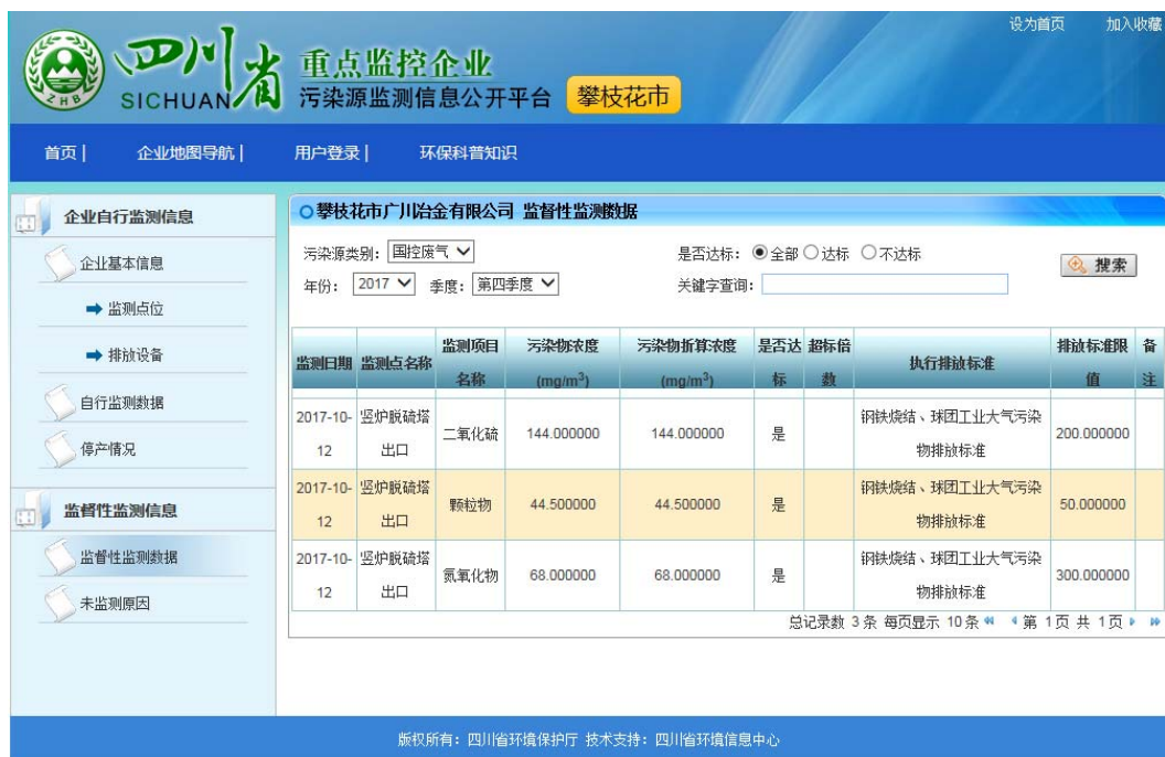
图 2-1 原有项目竖炉焙烧烟气排放在线监测结果
