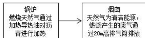
图4-3 锅炉废气处理措施
