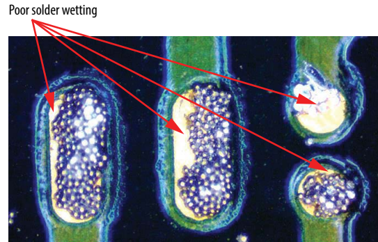
图16: 不良焊锡熔化的例子。
