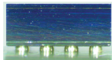
图3: 正确安装的eGaN器件(侧面视图)。
