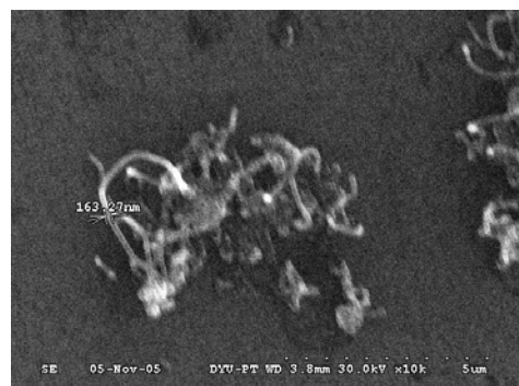
圖 4. 奈米碳管 SEM（前處理溫度 900^\circ\text{C} ）
